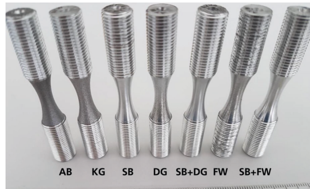
Abb. 1: Im Laser Powder Bed Fusion Verfahren gefertigte Ermüdungsproben aus AlSi10Mg: AB (as built); KG (as built + kugelgestrahlt), SB (spanend bearbeitet, d.h. abgedreht), DG (as built + diamantgeglättet), SB+DG (spanend bearbeitet + diamantgeglättet), FW (as built + festgewalzt), SB+FW (spanend bearbeitet + festgewalzt)
