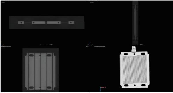
Abb. 3: Computertomographische Aufnahme einer Bipolarplatte aus Aluminium mit integrierten Kühlkanälen
