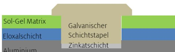
Abb. 1: Material und Schichtaufbau
