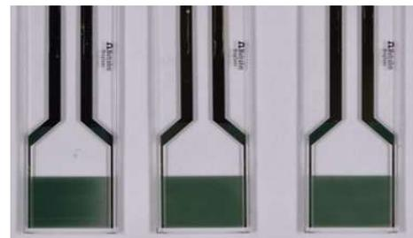
Abb. 2: Interdigitalelektrode mit Goldleiterbahnen, potentiostatische Abscheidung von Polyanilin bei 0,85V – Schichtdicke ca. 0,5-1µm
