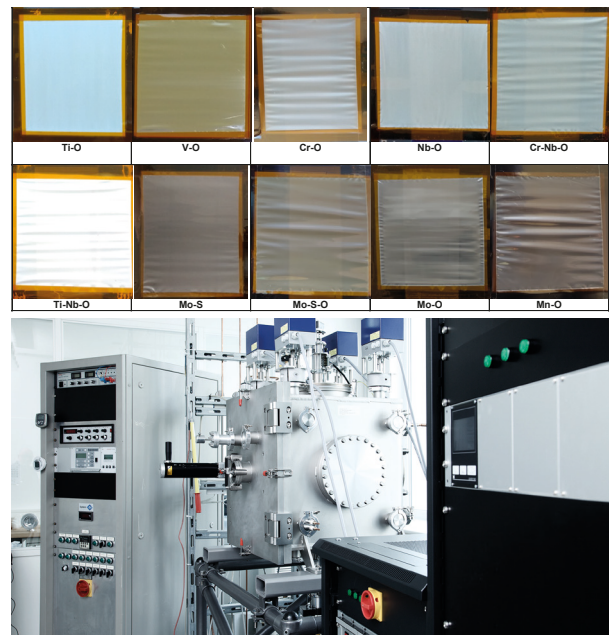
Abb.2: Separatorbeschichtungen von unterschiedlichen Übergangsmetalloxiden (oben); PVD-Beschichtungsanlage (unten).
