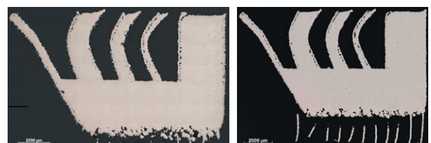
Abb. 1: Metallographische Untersuchung des aus beschichtetem Cu-Legierungen hergestellten Testteils. a): CuCrZr + Nb, Prozessparameter 250W, 600mm/s, Spurbstand = 0,055mm, Porosität 0,02 %. b) CuNiSiCr + Cr, Prozessparameter 200W, 900mm/s, Spurbstand = 0,055mm, Porosität 0,04 %
