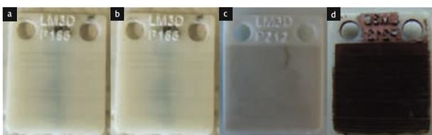
Abb.3: Substrate aktiviert mit A3; a) unstrukturiert nach Aktivierung, b) unstrukturiert nach Aktivierung und Metallisierung, c) laserstrukturiert nach Aktivierung und d) laserstrukturiert nach Aktivierung und Metallisierung
