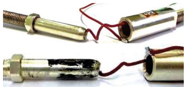
Abb. 1: Steckverbinder für Hochstromanwendungen im Neuzustand (oben) und nach 10,5 Mio. Reibzyklen (unten) [1]
