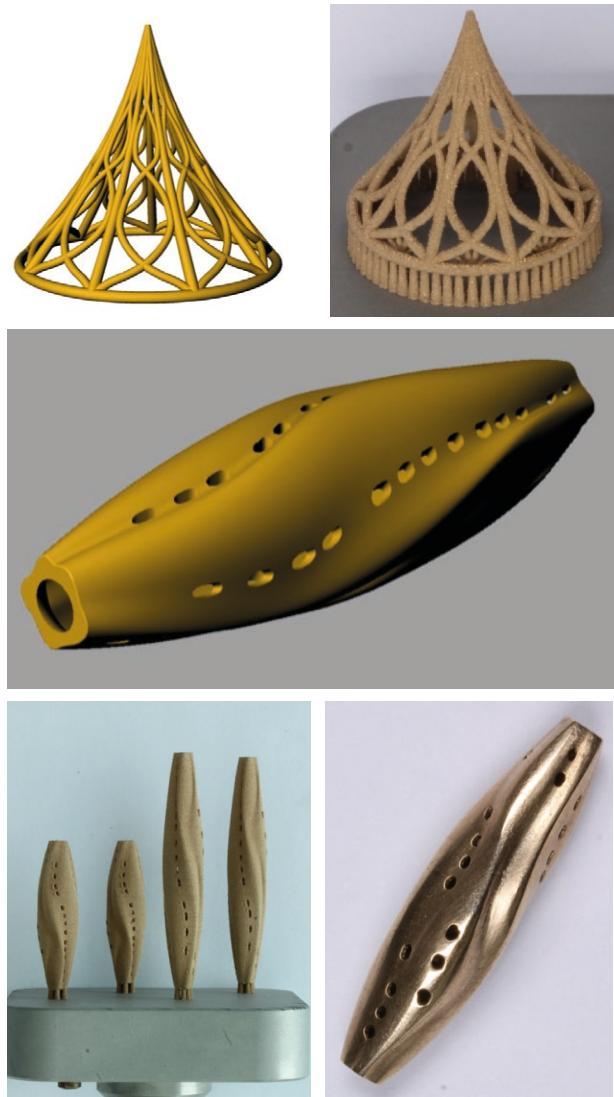
Abb. 1: Demonstrator Teile aus einem Forschungsprojekt zur additiven Fertigung von Goldlegierungen aus Bronze (oben rechts, unten links) und Gold (unten rechts)
