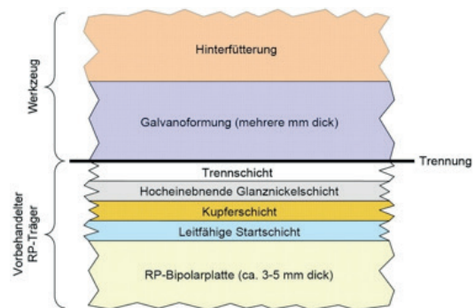
Abb. 1 | Schichtaufbau bei der Herstellung der Galvanoform aus einem RP-Positiv einer Bipolarplatte
