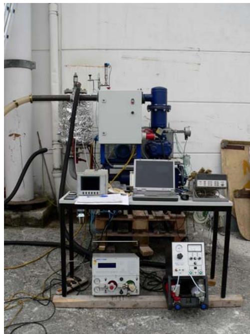
Abb. 3: Pilotanlage mit Abgaskatalysator (Alu umwickelt, links) , Saugzuggebläse (blau) und Steuerung (grauer Schaltkasten) im Einsatz vor Ort
