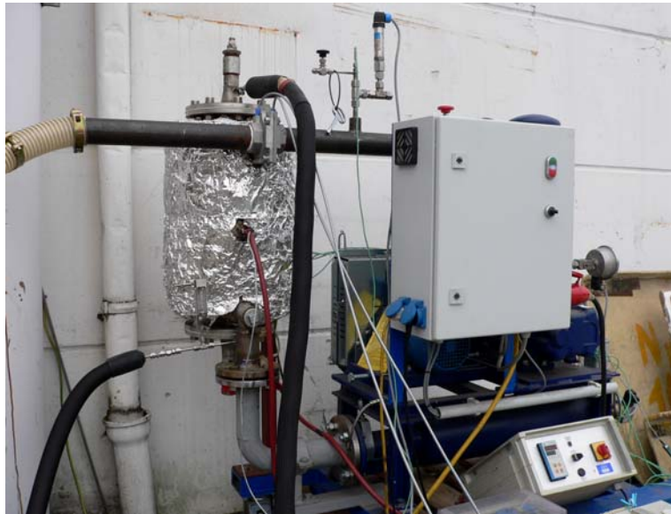
Abb. 3: Pilotanlage mit Abgaskatalysator (Alu umwickelt, links) , Saugzuggebläse (blau) und Steuerung (grauer Schaltkasten) im Einsatz vor Ort
