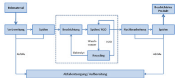
Abb. 4 | Prozessschema eines optimierten Beschichtungsprozesses
