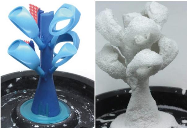
Abb. 2 | Herstellung der Formschale
