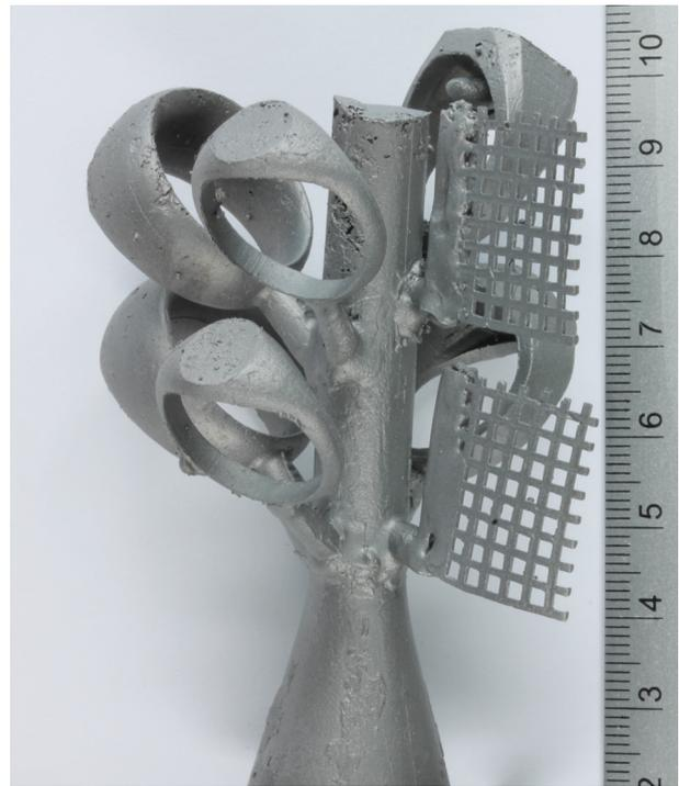
Abb. 3 | Gussbaum aus NiTi weist nur geringe Reaktion mit der Einbettmasse auf
